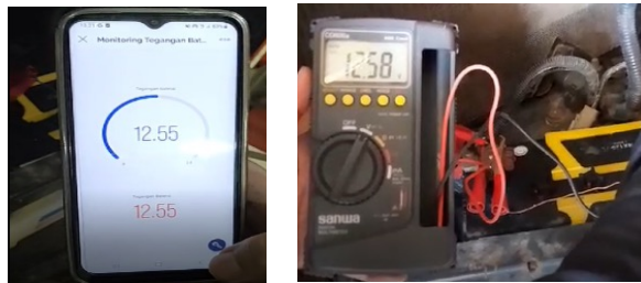
Gambar 9 Monitoring tegangan di aplikasi blynk pada saat engine mati
