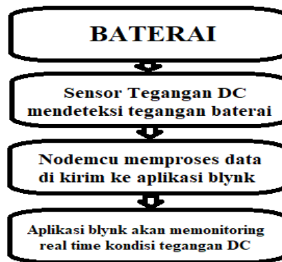
Gambar 3 Diagram alur kerja sistem monitoring kondisi tegangan baterai
