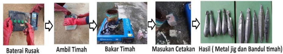
Gambar 5 Proses pembuatan produk pemanfaatan limbah baterai
